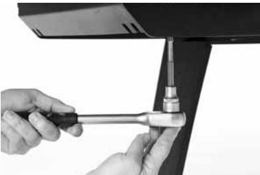
**12 |** Ziehen Sie erst jetzt die beiden kurzen Senkkopfschrauben M10 x 30 mm und dann die langen M10 x 55 mm fest an der jeweiligen Tischplattenhälfte an.
