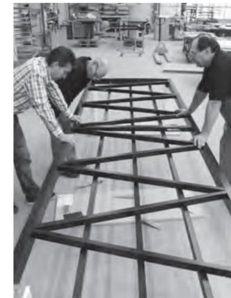
16 Personen können an diesem repräsentativen Tisch dinieren und die Aussicht auf Manhattan genießen. Diese bisher einmalige Sonderanfertigung besteht aus 2 Tischplatten mit gespiegelter Maserung. Trotz der Länge von 4,26 Metern und dem hohen Gewicht konnte mit der einteiligen Stahlrahmenkonstruktion und den vier außenliegenden Beinen
