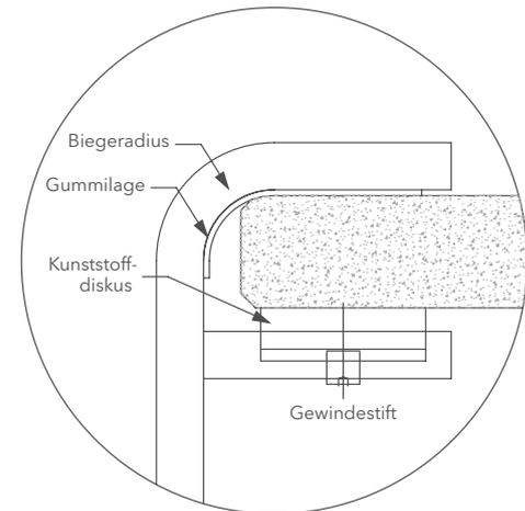
2 | Das Klebeband unterhalb der Kufen entfernen und die Gewindestifte mit Innensechskant lösen.
