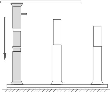
**1** Der Unterbau ist bereits vormontiert. Zuerst stecken Sie die 3 mitgelieferten Metall Ringe auf die Standrohre. Stecken Sie auf das niedrigste Fußrohr die kleinste Glasplatte.
