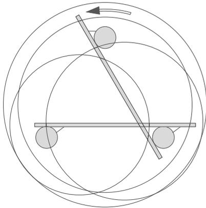
**4 |** Schwenken Sie die Glasplatten übereinander, dann können Sie die Schubstangen mit den Zapfen in die Bohrungen der Schwenkrohre einstecken.
