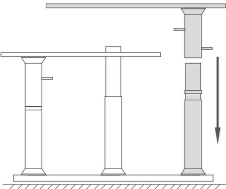
**2** Die mittlere Glasplatte auf das mittlere Fußrohr.
