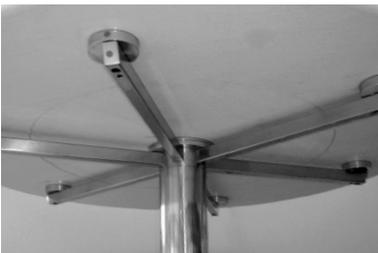
**3 |** Beim nächsten Vorgang muss unbedingt darauf geachtet werden, dass der Tischplattenring nicht mit der Innenplatte kollidiert (nur 1 mm Spalt vorhanden)! Den Ring vorsichtig über die Innenplatte anheben und so auf den Unterbau absetzen, dass die 6 Klebeteile mit den 6 Bohrungen in den Streben fluchten. Die Markierungen am Klebeteil und am Tragarm müssen jeweils übereinstimmen! Die Markierungen am Klebeteil und am Tragarm müssen jeweils übereinstimmen!
