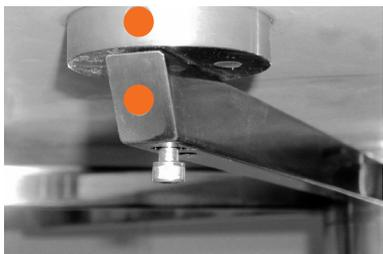
**4 |** Die 6 Zylinderkopfschrauben von unten in die äußeren Bohrungen der Streben eindrehen und damit die Klebeteile befestigen. Die Schrauben keinesfalls zu fest anziehen, gut "handfest" anziehen reicht völlig aus.
